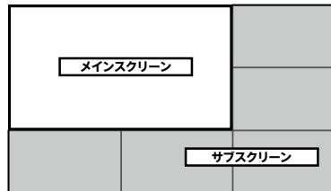
本製品のブラウザ機能を使用するときの表示は左図のように、画面左上の大きなスクリーンを「メインスクリーン」、周りに表示される小さなスクリーンを「サブスクリーン」と呼びます。
